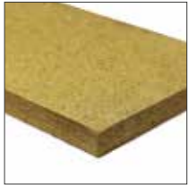
Habillage intérieur en vermiculite et réfractaire à la base.
