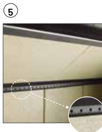
5 Air tertiaire ou de sécurité. Constitue un apport supplémentaire en oxygène permettant de mieux brûler les gaz de combustion.
