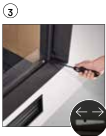
3 Manette de réglage d'air secondaire. Mécanisme permettant d'alimenter la combustion en oxygène à travers la double combustion et la partie supérieure de la vitre.
