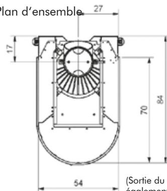
(Sortie du conduit de fumée également possible à l'arrière)
