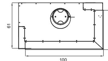
(Sortie du conduit de fumée également possible à l'arrière)
