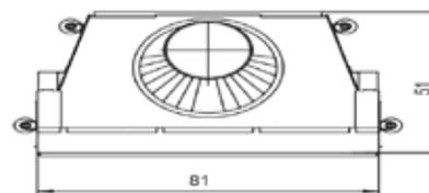
(Sortie du conduit de fumée également possible à l'arrière)
