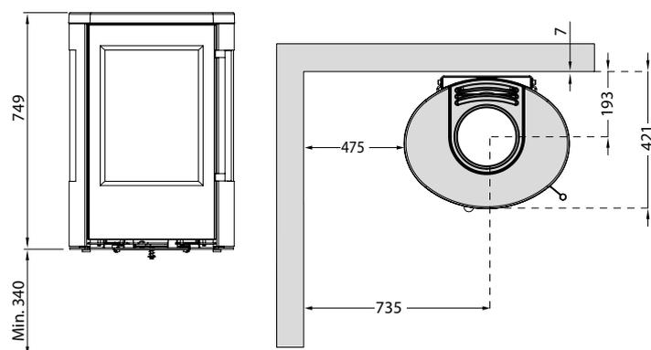
Le TT23RGW est conçu pour une installation sur un mur ininflammable. Si votre sol est inflammable, le poêle doit être posé à 340 mm minimum du sol. Pour une solution de montage optimale et sécuritaire, veuillez consulter votre revendeur-installateur agréé.
