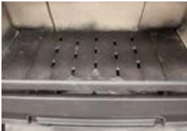
Sole en fonte avec trappe de déchargement
