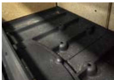
Sole en fonte avec trappe de déchargement
