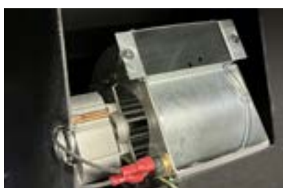
Détail ventilateur droit en cours d'assemblage
