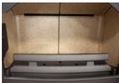
Intérieur vermiculite haute densité
